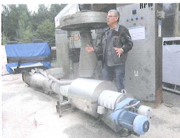
Fot. 3. Widok (w pozycji leżącej) aeratora powierzchniowego pływającego typu Agua Vulcan o mocy 15 kW, własności ZGKiM w Stąporkowie.
