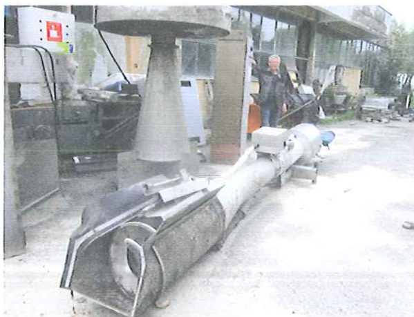
Fot. 4. Widok aeratora powierzchniowego pływającego typu Agua Vulcan o mocy 15 kW, własności ZGKiM w Stąporkowie.
